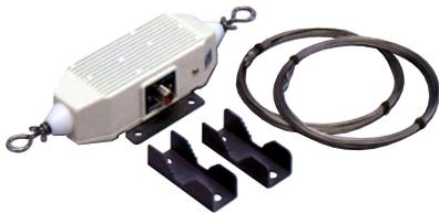
Para adaptar el transceptor a una antena dipolo. Cubre todas las bandas de AF desde 1.5 a 30 MHz. Vienen unidos cables de antena de 8 m (26.2 pies) x 2.
